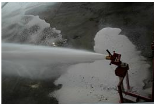
Figuur 5.8 b – Voorbeeld van een automatisch oscilerende monitor met schuimconcentraatbijmenging, zonder IBC-reservoir
